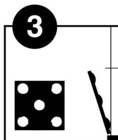
Tomamos la placa y le colocamos el adhesivo como muestra la figura, repartiendo en 5 puntos y en los extremos a no menos de 5 cm, ya que se pueden quebrar las esquinas cuando hagamos presión en el momento de colocación. La placa se apoya en el zócalo y se busca el nivel anteriormente marcado.
