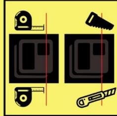
Primero medimos la longitud del corte. luego marcamos con una regla la línea y por último cortamos con un Cutter o sierra chica.
