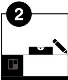
Trasladamos el nivel a todos los muros del ambiente que revestiremos y marcamos con un lápiz la línea que nos indicara el nivel de colocación.
